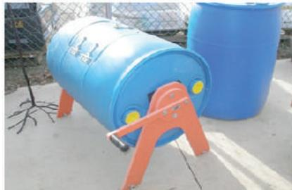
Pengkomposan In-Vessel secara Manual
