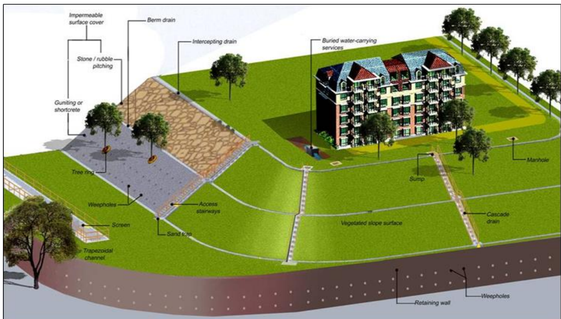
Rajah 5: Sistem Saliran Permukaan Cerun
